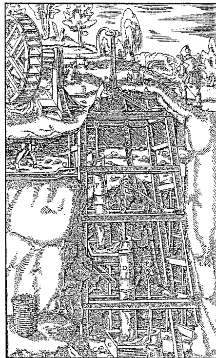
5. ábra: Háromrészleges vízkerékhajtású szivattyú
