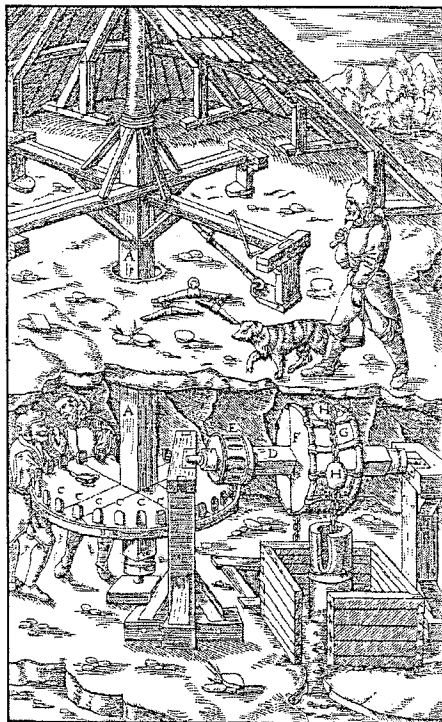
4. ábra: Járgánnyal hajtott labdás vízemelő gép
